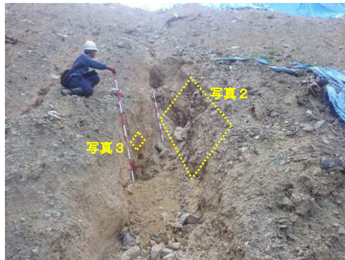
写真1 ガリー侵食の状況。深さ 1.5m 程度。底盤に礫岩が分布する。
