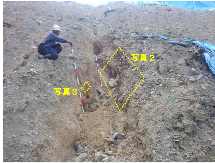
写真1 ガリー侵食の状況。深さ 1.5m 程度。底盤に礫岩が分布する。
